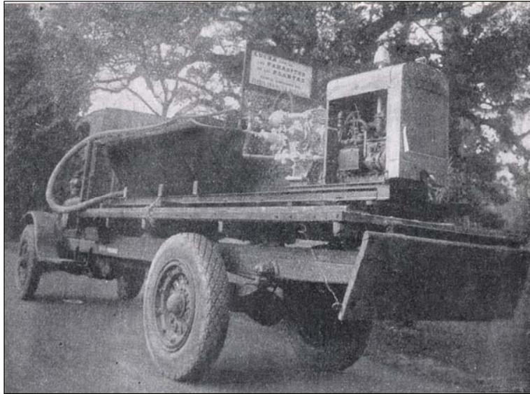
**Un equipo moderno y potente de pulverización de los que se utilizan en la Argentina para la desinfección de frutales**
